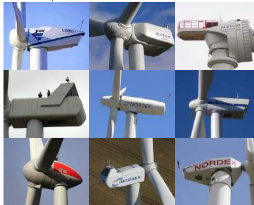
Figure 119: Différentes formes de nacelles Ces exemples illustrent parfaitement qu'une normalisation dans ce domaine est illusoire. D'ailleurs les parcs compris au sein de l'aire d'étude sont constitués de machines produites par les constructeurs les plus variés.
